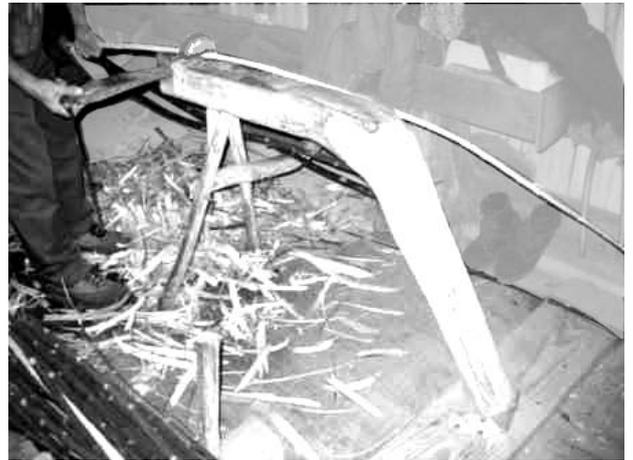
*L'ouvrier bloque le feuillard sur le banc à l'aide du crochet et de la cale avant de commencer le ripage*
